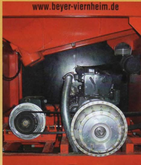
Dieselmotorischer Antrieb über Keilriemengetriebe. Erzeugung von elektrischem Strom im Nebetrieb
