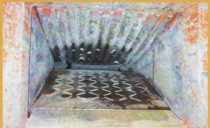
Maulweite 700 x 500 Brecherplatten aus hochverschleißfestem Manganguß
