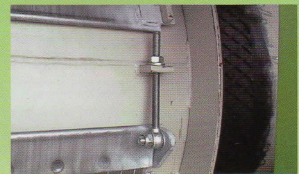
Der Siebbelag wird einfach auf die Grundtrommel aufgespannt
