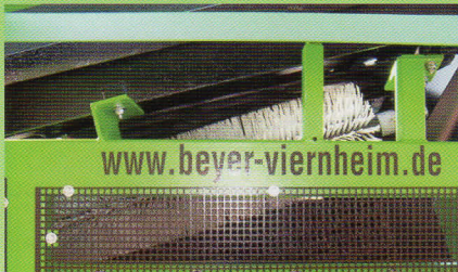
Eingebaute Reinigungsbürste für verstopfungsfreies Absieben
